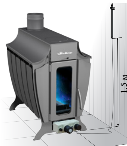
Рисунок-12 Расположение термодатчика на стене.
