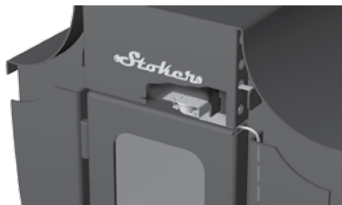
Рисунок-11. Установка датчика тяги. Закрепить датчик тяги саморезом. Кабель датчика спрятать за передним кожухом
