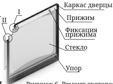
Рисунок 6. Ремонт светорозрачного экрана дверцы модификации «Люмина»
