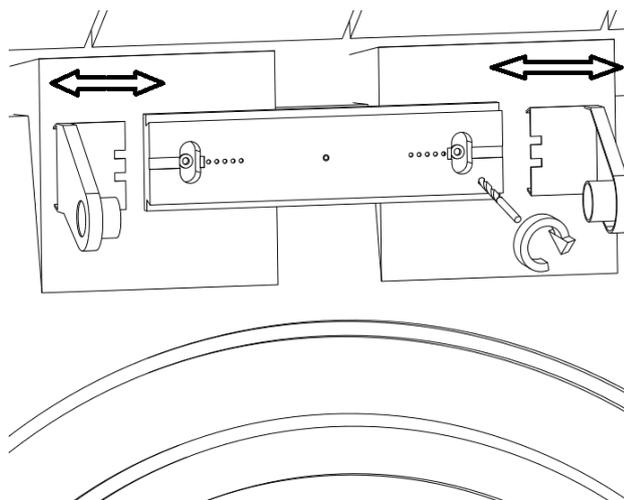
3.24. На боковой панели просверлить два отверстия и закрепить вытяжными заклепками (4.8x16 мм) диспенсер для мыла:
