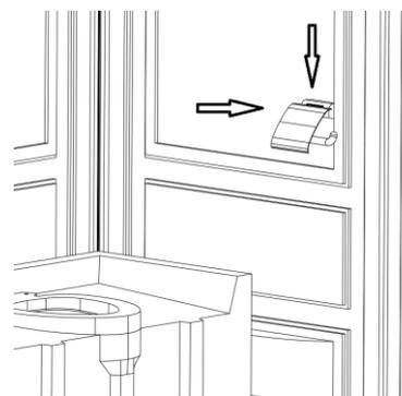
3.13. На внутренней стороне передней лицевой панели, просверлить отверстия для закрепления задвижки и крючка для одежды. Заклепать крючок и задвижку лепестковыми заклепками (4,8x21 мм):
