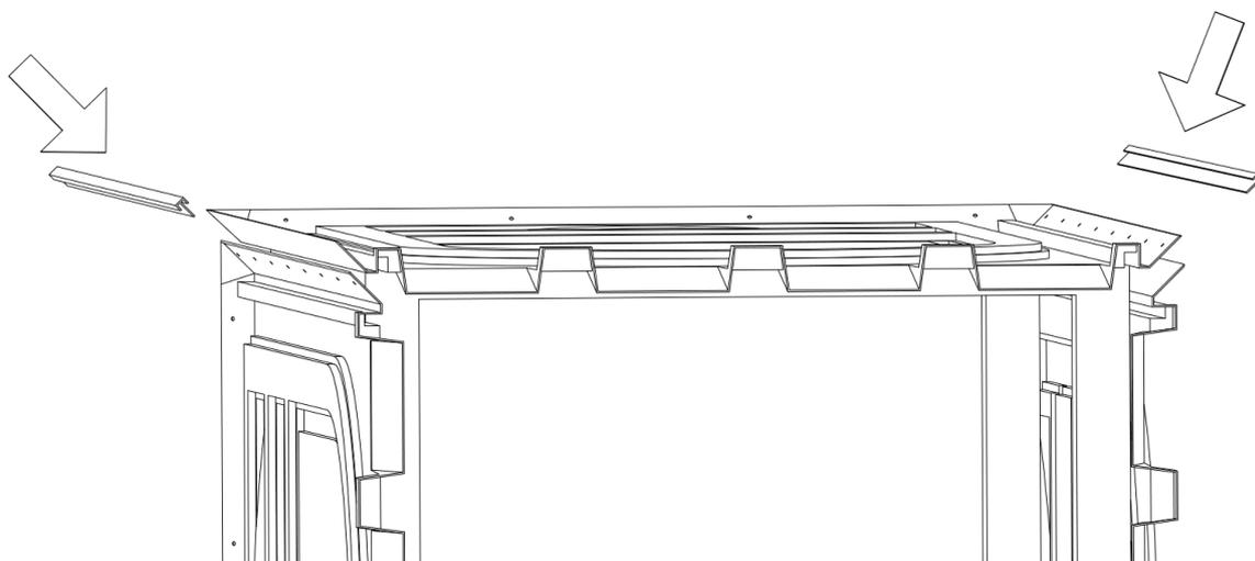
3.3. Выровнять Ш-профиль по нижней части боковой панели согласно эскизу.
