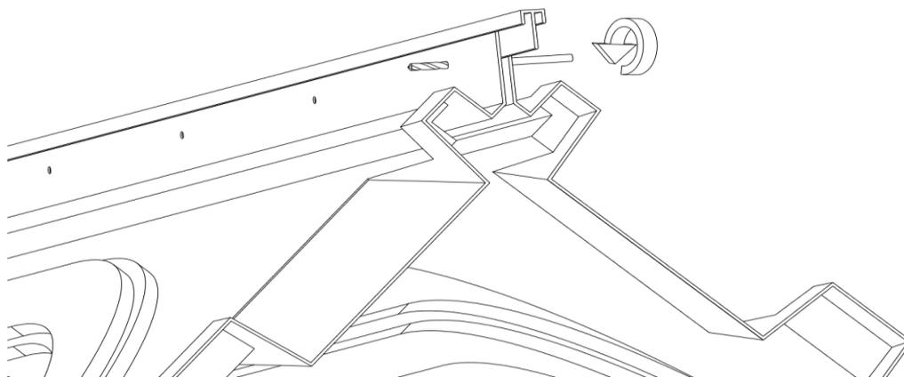
3.5. В просверленное отверстие вставить вытяжную заклепку (4,8x18мм), одеть шайбу и заклепать\*:
