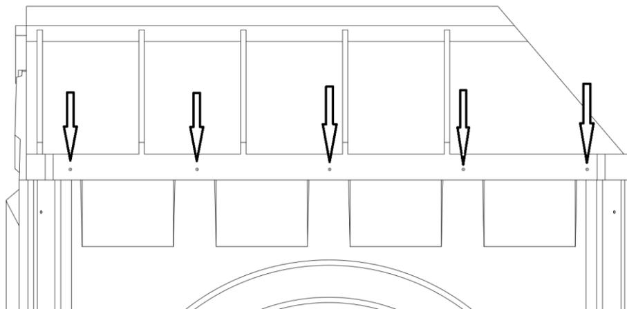
3.21. Просверлить отверстия в двери и закрепить лепестковыми заклепками (4,8x18 мм) проушину для замка. Вторую проушину закрепить таким же образом на арке:
