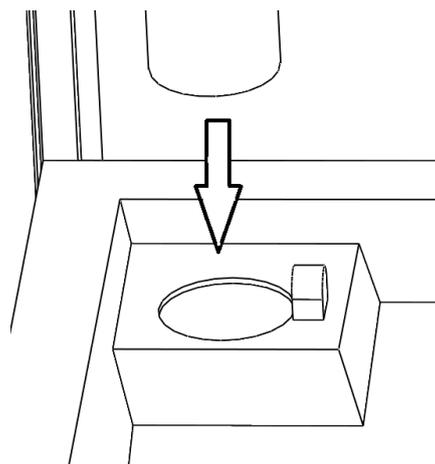
3.12. Просверлить два отверстия диаметром 5 мм в бумагодержателе и боковой панели. Закрепить бумагодержатель на боковой панели с помощью вытяжных заклепок (4,8x18 мм):
