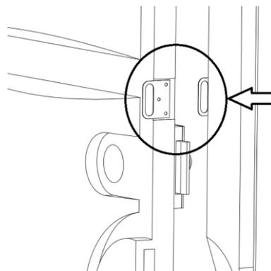
3.22. Вытяжную трубу поднять до упора в крыше и закрепить ее шурупом через специальный кронштейн в баке:
