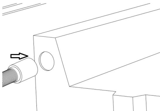
3.27. Разместить блок умывальника в плотную к боковой панели и просверлить два отверстия с внешней стороны. Далее закрепить умывальник лепестковыми заклепками (4,8x18 мм):
