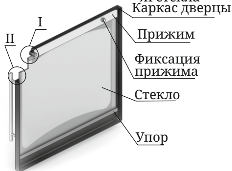
Рисунок 14. Ремонт светорозрачного экрана дверцы модификации «Витра»
